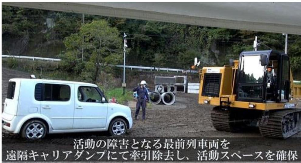
ARAV社の遠隔技術は、4G/LTEをインフラとして、建機本体の車載カメラ映像を、遠隔地に設置したモニターで受信、遠隔オペレーターが操作信号を送信する事で、建機を稼働させるものであるが、インターネット環境が整わない工事現場、災害現場を想定し、ローカルネットワーキング構築技術パートナーを必要としていた。
