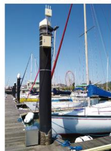
栈橋に設置された「PCWL-0410」 IP67相当の防塵・防水性を備えているため 屋外でも安定した通信環境を提供
