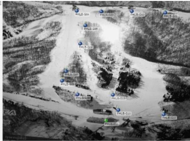
5クタールのゲレンデを10台のマルチホップ機能付Wi-Fiエッジコンピュータ群でカバー。
